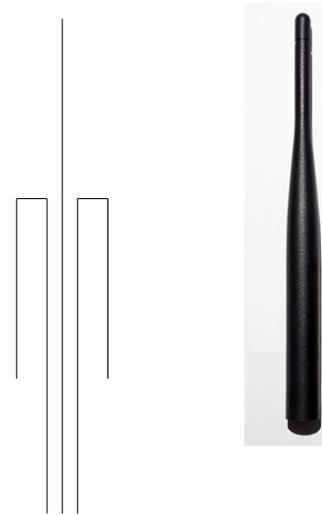
Sleeve dipole, pas de plan de masse
