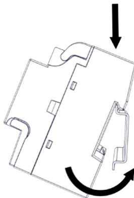
1. Poser l'évidement de l'appareil sur le bord supérieur du rail porteur
