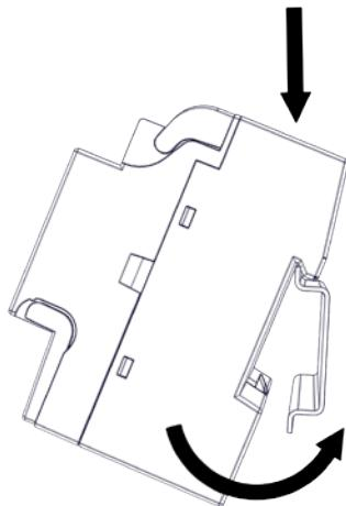
1. Geräteaussparung auf Oberkante der Tragschiene auflegen
