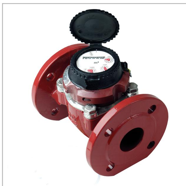
Die Baureihe RUBIN arbeitet nach dem Geschwindigkeits-Messprinzip mit Woltman-Turbine und ist für die Grosswassermessung konzipiert. Das komplette und modulare Sortiment deckt einen breiten Messbereich auf allen Gebieten der Wasserversorgungstechnik als Durchflussmesser oder Durchflusssensor für Komplettmessstellen.
