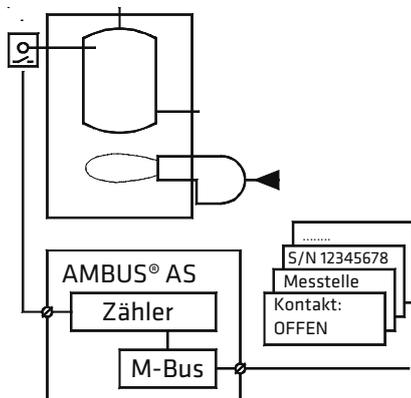
Als Alarm- bzw. Statusmelder parametrierbar liest AMBUS® IS eingehende binäre Signale eines Gerätes und ermöglicht, den Signalstatus und die Anzahl Ereignisse über ein M-Bus Netzwerk fernauszulesen.
