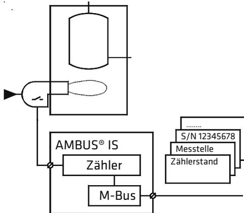
Als Impulssammler parametrierbar sammelt AMBUS® IS eingehende Impul-se eines Gerätes in einem Zählerregister und ermöglicht, den Zähler über ein M-Bus Netzwerk fernauszulesen.
