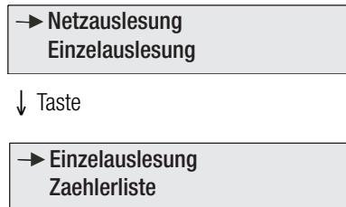
Nach Eingabe des Passcodes und Abschluss der Eingabe mit der E-Taste gelangt man ins Hauptmenü. Hier sind zunächst die Punkte „Netzauslesung“ und „Einzelauslesung“ sichtbar. Durch Betätigung der ↓ Tasten wird ein neuer Ausschnitt des Hauptmenüs angezeigt und „Einzelauslesung“ ausgewählt. Durch Drücken der E-Taste wird das selektierte Untermenü aktiviert.
