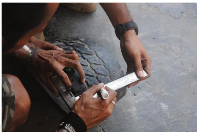
5. Corte a banda de rodagem com uma faca bem afiada até sentir os fios de aço. Você precisará afiar a ponta da lâmina depois disso. (Geralmente, há algumas camadas de fio de nylon sobre os fios de aço que você precisará passar.)
