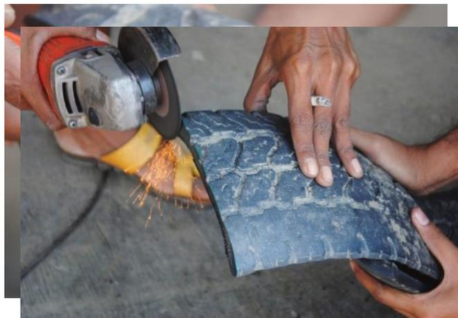
6. Usando um disco de corte metal mais fino disponível, corte com cuidado e ordenadamente as 2-3 camadas de fios de aço no pneu e pare assim que passar pelo aço, porque você pode cortar o restante de borracha com uma faca muito mais precisa e com menos fumaça. Isso é mais bem feito com o pneu em uma morsa. Adicione água ao pneu conforme você avança e ele não soltará fumaça. Não respire a fumaça de um pneu soltando fumaça.
