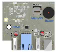
Wenn einmal der seltene Fall eintreten sollte, dass die WebLog weder per Touchscreen noch per Webbrowser bedienbar ist, kann durch Drücken des RESET-Tasters in der linken oberen Ecke des Klemmenraums ein System-Neustart erzwungen werden.
