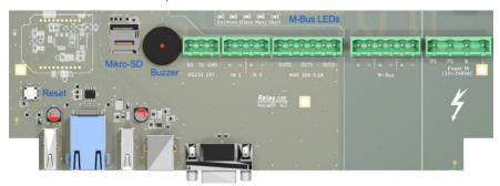
Zum Anschluss des M-Bus stehen drei gleichwertige 2-polige steckbare Schraubklemmen zur Verfügung. Die Netzversorgung von 110 bis 240VAC sollte von einem Elektriker in der steckbaren Schraubklemme rechts außen angebracht werden. Phase, Nullleiter und Schutzleiter sind mit L, N und dem PE gekennzeichnet. Die restlichen Steckklemmen sind für zukünftige Erweiterungen vorgesehen.
