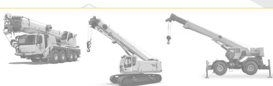
Grue automotrice à flèche télescopique qui peut être montée sur un mât (tour), capable de se déplacer en charge ou à vide sans avoir besoin de voie de roulement fixe et qui demeure stable sous l'influence de la gravité
