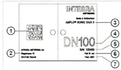
**Frontplatte an der Messelektronik**
