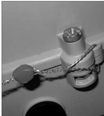
Plomben an den 2 Befestigungsschrauben des Messumformers
