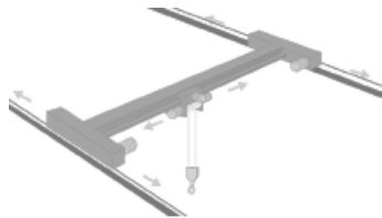
Pont monopoutre posé
