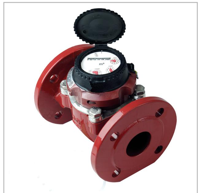
La gamme RUBIN fonctionne selon le principe dit "de vitesse". Elle est équipée de la turbine Woltman et est destinée aux grands débits. L'assortiment complet et modulaire couvre une plage de mesure étendue dans tous les domaines de la technique d'alimentation en eau. Comme débitmètre ou sonde de débit pour système de mesure complet.
