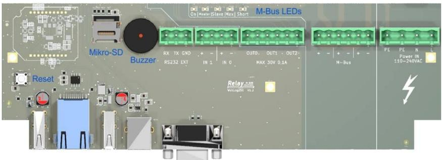
Trois bornes à vis enfichables bipolaires équivalentes sont disponibles pour le raccordement du M-Bus. L'alimentation secteur de 110 à 240VAC doit être placée par un électricien dans la borne à vis enfichable à l'extérieur à droite. La phase, le neutre et le conducteur de protection sont marqués L, N et PE. Les autres bornes enfichables sont prévues pour des extensions futures.
