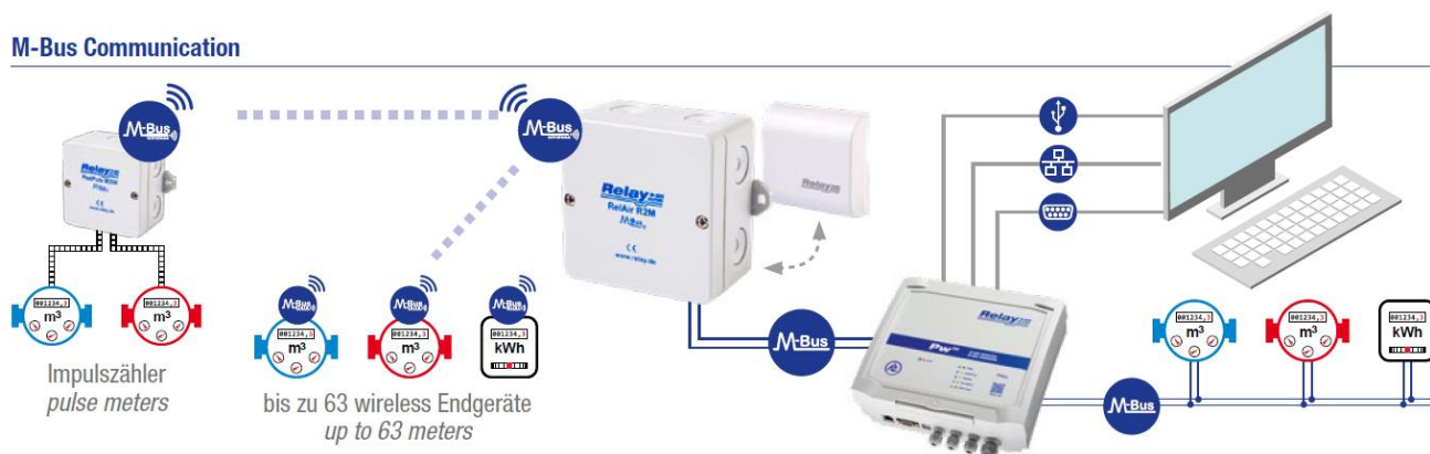
Photo : Système M-Bus sans fil avec PadPuls M2W, passerelle RelAir R2M et PW250
