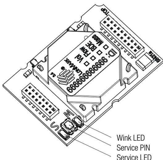
Le circuit comporte une 'LED de service'. Cette LED (diode électroluminescente) permet d'interpréter l'état du système conformément au code de clignotement suivant :
